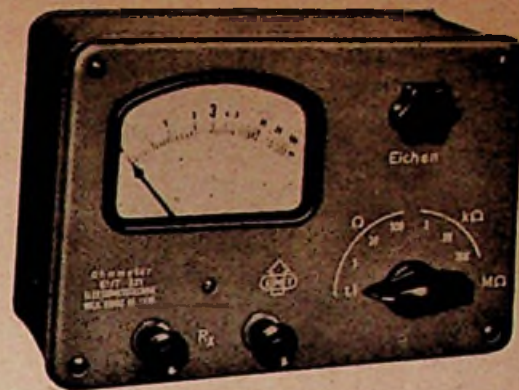
Direct-aanwijzende ohm-meter type EMT 321 van Wilhelm Franz, 10 milli-ohm tot 100 megohm. (Stand 27)
